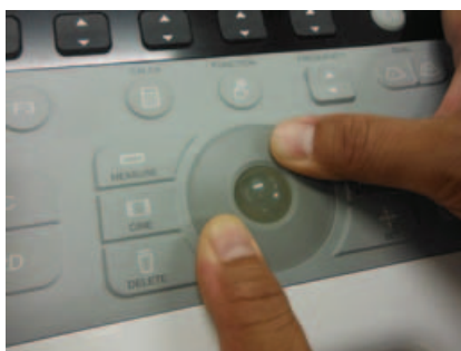
図 8-2: トラックボールのフタを外す
